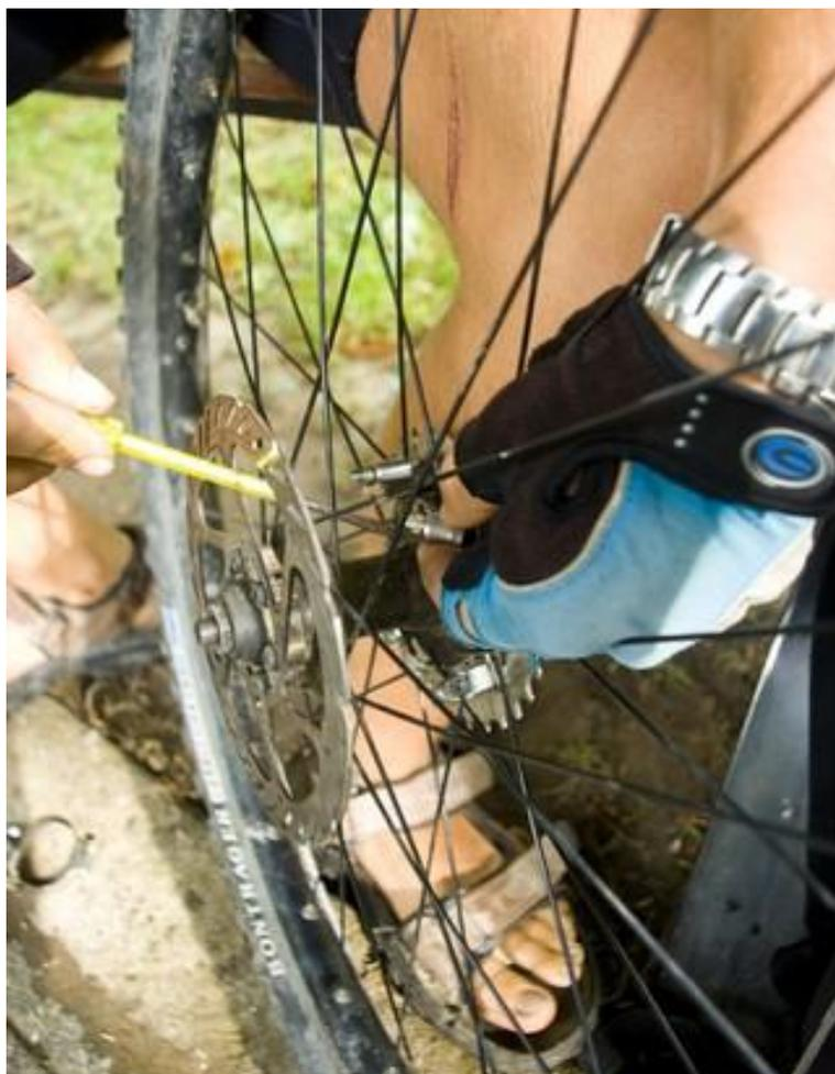
Фото № 116. Ремонт: соединение кассеты и спиц хомутами.
